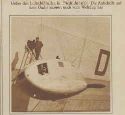
Eine der fünf Motorgondeln, in die man über eine Leiter aus dem Innern des Luftschiffes gelangt
