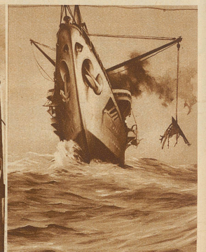
Abgelöste Wrackteile, welche die Arbeit des Tauchers gefährden könnten, werden an Bord gezogen
