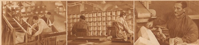
Die Verpackung, wo die Kleinmengen für Orte und Rotten in Säcke gelegt werden. Die abgemessenen Sendungsmenge gelangen über Spritzen und Laufbänder auf den Bahnpöschwagen
