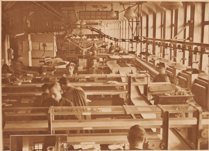
Die mechanische Briefsortierung bringt die Kleinmengen zum Briefverwand. Der Briefauftrag entleert die Briefe über eine kleine Röhre auf einen Einzelfisch
