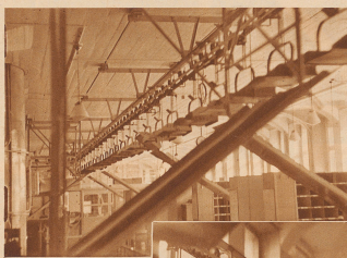
Die mechanische Briefsortierung bringt die Kleinmengen zum Briefverwand. Der Briefauftrag entleert die Briefe über eine kleine Rutsche auf einen Einzelfisch
