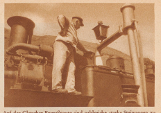
Auf der Gletscher-Expressfahrt sind zahlreiche stark Steigungen zu überwinden. Kraftanstrengung und Dampfverbrauch der kleinen Lokomotive sind sehr groß. Meistens wird während der Fahrt mit Wasser gefüllt werden.
