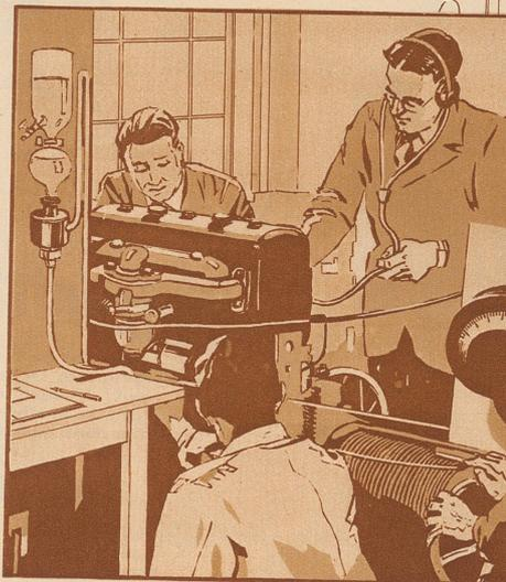
Das Standard-Verfahren, das Millionen von Franken für Versuche gekostet hat und für dauernde Kontrollmaßnahmen ständig hohe Mittel erfordert, bürgt für die Zuverlässigkeit und Gleichmäßigkeit der Standard-Erzeugnisse. Auf eigenen Prüfständen wird die Wirkung der Standard Erzeugnisse an Versuchsmotoren untersucht und gemessen.
