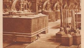
Wagen mit frischer Tonerde. Rechts neue Elektroden
