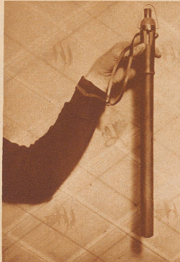
Der Gasmummknüttel , der kürzlich an der Leipziger Messe von einer Berliner Waffenfabrik gezeigt wurde. An dem Gummknüttel, der als Schlagwaffe benutzt wird, ist ein Scheintodrevolver angebracht; drückt man auf einen Hebel, dann explodiert die Gaspatrone und der Gegner wird auf eine Viertelstunde außer Kampf gesetzt.
