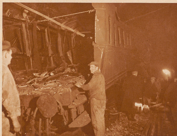
Der Gotthardzug von hinten nach vorn gesehen. Das freie Geleise liegt zur Rechten. Ein Gepäckwagen hatte sich von rückwärts in den Personenwagen hineingeschoben. Er ist bereits abgeschleppt worden
