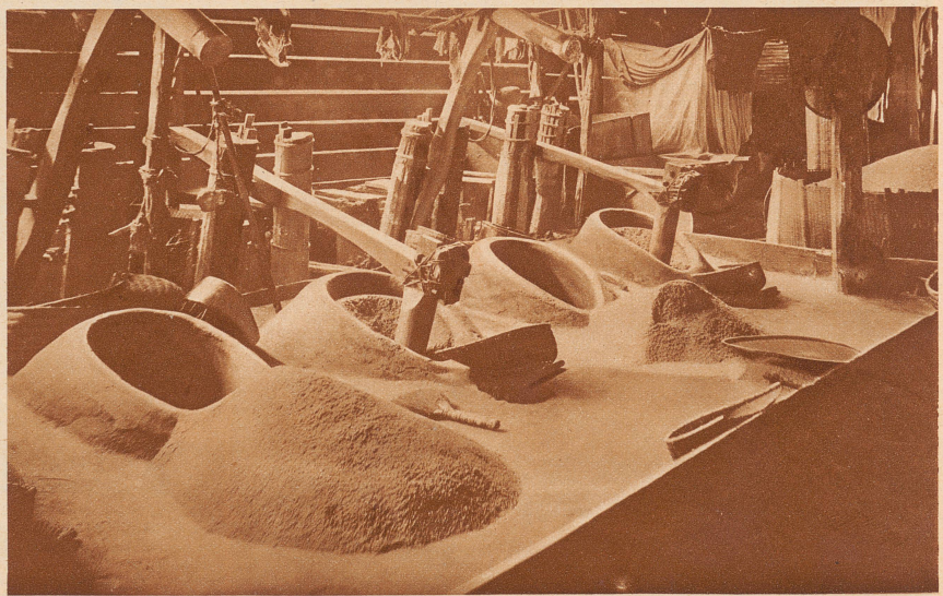
Primitive siamesische Reismühle, auch jetzt noch im Gebrauch bei den Eingeborenen Siams
