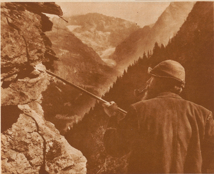
Mit einer Eisenstange werden die Felsen angebrochen, und mit einem Haken die Kristalle aus dem gelockerten Gestein herausgezogen
