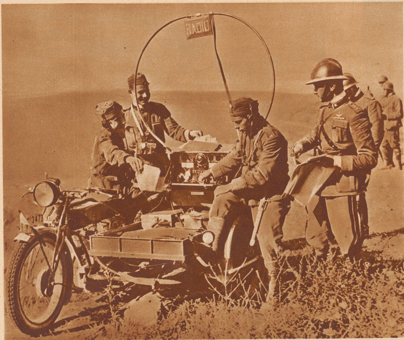
Radiowagen des italienischen Feldheeres. Zum erstmaligen wurden in den eben zu Ende gegangenen großen Manövern der italienischen Armee in Piemont Motorräder mit Radiobeiwagen verwendet
