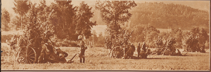
Feldartillerie im Jahre 1933. Die kompliziertere Feuerleitung bei der Artillerie bringt es mit sich, daß auch heute noch die Geschütze einer Batterie auf relativ engem Räume mit 25-30 Meter Zwischenräumen aufgestellt werden müssen. Aber die Vervollkommenung der Beobachtungsapparate, vor allem aber die Fernrohrbestimmung hat es mit sich gebracht, daß auch der Artillerie parallel damit befohlen wird, die Geschützstellungen zu maskieren. (Hierbei hier geringe Batteriestellung mit ihrer angeordneten Maskierung entspricht allerdings nicht den Anforderungen des modernen Kampfes; aber Vierzehnten über Vermehrung von Beobachtern lassen sich im Frontbereich die Artillerieführer Rückwärts nehmen, die im Kampf von selbst abhinken.)
