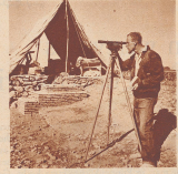
Täglich stellt der Topograph mit dem Vermessungsinstrument den Stand der Ausgrabung fest.
