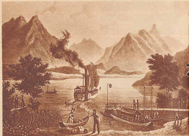
Die «Bellevue», der erste Dampfer auf dem Thunersee. Der Raddampfer war in Paris gebaut. Die Bestandteile wurden einzeln auf Fuhrwerken von Paris nach Thun transportiert und dort montiert. Am 31. Juli nahm die «Bellevue» ihre regelmäßigen Fahrten auf.
