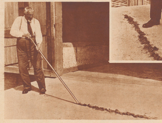
Die mit der Sode angereicherte Probe wird mit Hilfe eines Holzkloßes angeschnitten. Die Probe besteht aus einem stark zusammengepreßten wasserfestigen Gebilde aus Heu.
