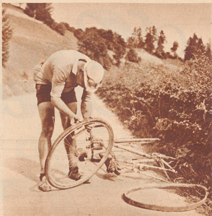
Der Ersatzreifen am Ort. Es gibt Fahrer, die ihn nach alter Weise mit einer Handpumpe aufpumpen, andere haben einen kleinen Tubus mit komprimierter Luft, eine Art Stahlflasche im Kleinen, bei sich, den setzen sie an und mit Sekundenschnelle ist der Reifen prall gefüllt. So ein Tubus mit komprimierter Luft reicht für 4-5 Reifen.
