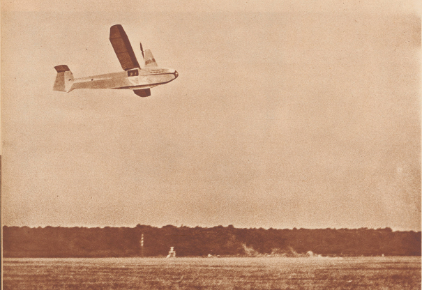
Für 5000 Mark von welthistorischer Bedeutung. Die erste Aufnahme vom Menschenflug am eigenen Kraft. Zahn Meter über der Erde. Flieg: Dinnbühl mit etwa 10 Meter Sekundengeschwindigkeit dahin. Der Propeller machte 350 Umdrehungen in der Minute.
