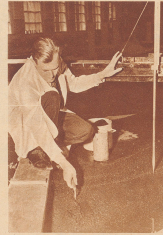
Die Ausbagger der Flußläufe des Modells erfolgt von Hand mit Hilfe einer Kelle. In den berechneten großen Gefällen werden die ausgebaggerten Mengen genau gemessen.
