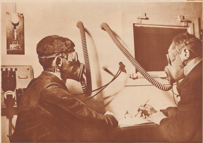
Die Gasmasken-Prüfer an der Arbeit. — Sie sitzen hier nicht in der Gaszelle, sondern in einem geschlossenen Raum. Hinter dem Fenster liegt die Gaszelle. So ist jetzt versagt. Durch die beiden Schläuche ansatz die zwei Prüfer die versagte Luft der Gaszelle. Die Masken sollen — wenn sie gut sind — aus der verpesterten Luft die Giftmoleküle des Giftes vollständig machen und das bedürftige die gute Luft bekommen lassen. Vorne sitzen in die Masken nach allen Seiten geöffnet worden, sind die chemischen Prozesse überträgt und die Wirkstoffe der Filter ausgegossen worden. Die beiden Prüfer sitzen da, machen ihre Notizen, achten auf die Zeit und achten gespannt darauf, ob es sich nur im entmenschten euren verdrängten Geruch bemerken oder irgendeine Krämpfe verspüren.
