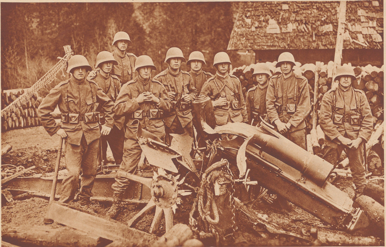
Das eine der zerstörten Geschütze. Rohr, Schutzschild, Verschluss, Schußbremsen, Richtmaschinerie und Räder sind total zertrümmert. Intakt geblieben ist die Lafette und zum Teil die Rohrwiege.
