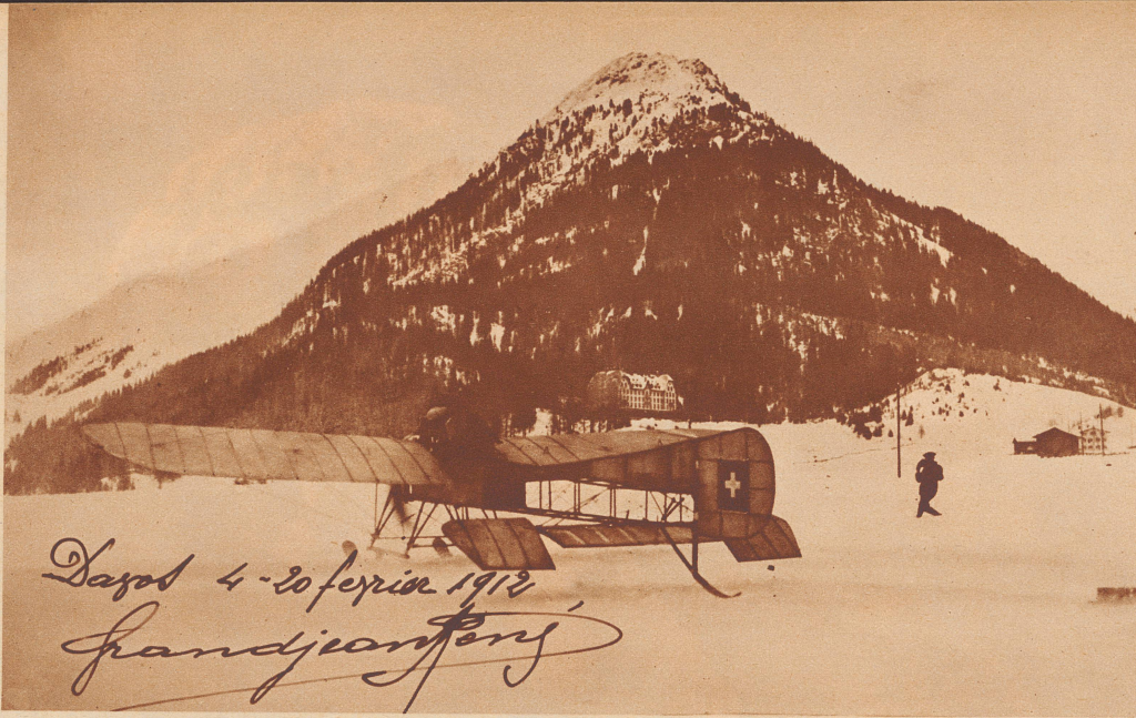
Im Winter 1911/12 kam Grandjean auf den Gedanken, sein Flugzeug für Start und Landung auf Schnee und Eis mit skiartigen Kufen auszurüsten. Bild: Grandjean startet mit seinem Ski-Flugzeug auf dem Davosersee im Februar 1912. Im Hintergrund das Seehorn und die Basler Heilstätte. ● Pendant l'hiver 1911-12 Grandjean eut l'idée de munir son avion de «glisses» semblables à des skis lui permettant un start sur neige et sur glace. Nous voyons ici Grandjean et son avion sur le lac de Davos.
