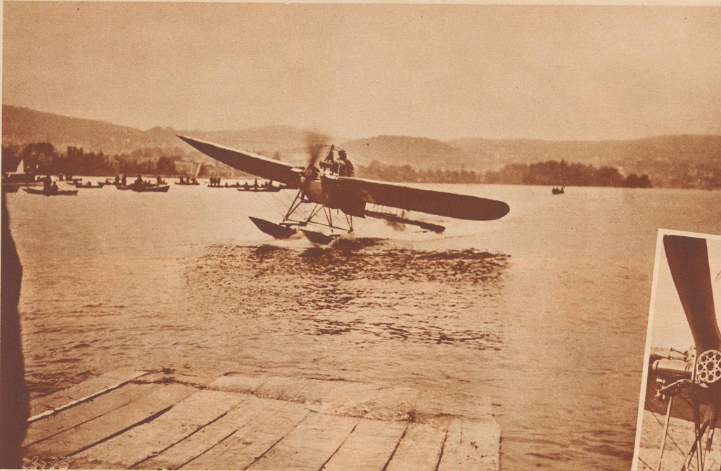
Im August 1912 machte Grandjean mit seinem durch Ersetzen der Fahrräder mit zwei Schwimmern in ein Wasserflugzeug umgewandelten Eindecker auf dem Zugersee die ersten Versuche, die vollauf gelangen. Am 4. September 1912 überflog er in 56 Minuten, 16 Sekunden den Genfersee von Chillon nach Versoix und gewann damit den Eynard-Preis von 10 000 Franken. Bild: Eine Wasserlandung Grandjeans auf dem Zürichsee im Oktober 1912. ● En septembre 1912 Grandjean survola le Léman de Chillon à Versoix et gagna le prix Eynard de 10 000 fr. Notre image: Grandjean amerrissant au mois d'octobre 1912 avec son hydro-avion sur le lac de Zurich.
