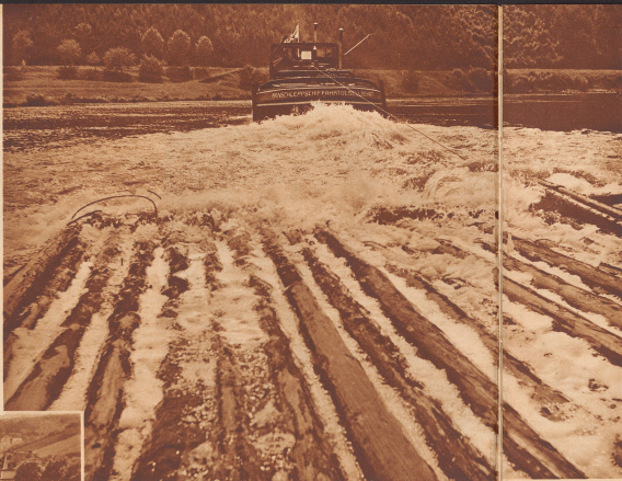
Im oberen Unterlauf wird der Main beinahe ohne ein Langenort. Deshalb vollzieht sich die zweite Hälfte der Reise von Lohr bis Mainz im Schlepptross Motorschiffe der Mainflößerei-Verkehrs-Gesellschaft. Die Gepeschwindigkeit beträgt nur 8-10 Kilometer pro Stunde. Le Main d'Algerie, sans cours devient plus calme, aussi fait-on remorquer le train flottage par un bateau de tonnage élevé à 12 kilomètres.
