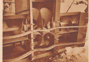
Blück im Maul der Schneeschleife: Der Traktor schleppt sie vor sich her. Von hinten quer über dieses abnehmende Maul zwei Schienen oder Messer, die auch festsitzende Lawenabschneidevorrichtungen. Die Zahl dieser Messer kann je nach Bedarf erhöht werden. Hinter den Messern fauen die Zubringer-Schienen, zwei auf jeder Seite der Schiene und schneifen ihn nach der Mitte zum Schlittenrad, welches ihn ergreift und durch den Kamin oben hinausdrückt. 15 Meter hoch!
