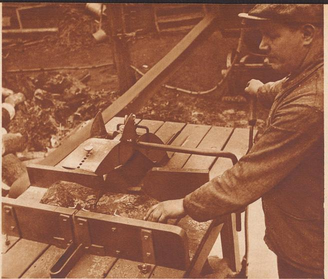
Beim Arbeiten mit der Schutzvorrichtung «Hatt» steht der Fräser neben dem Tisch. Mit einem Hebel führt er das festgeklemmte Rundholz dem Fräsenblatt entgegen. Ein Kontakt mit der scharfen, rotierenden Säge ist ausgeschlossen. Das Wegschlagen von Holzstücken ist unmöglich geworden.
