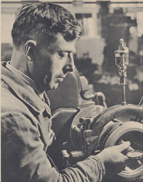
Spiegelt sich in dem Ausdruck des Arbeiters, der die Bohrung der Zylinderbüchse präzise auf ein Tausendstel-Millimeter bohrt, nicht das souveräne Bewußtsein löscher Fleißererei?
