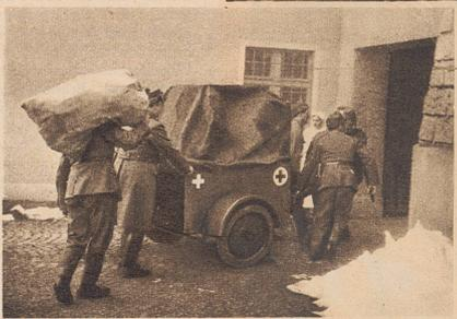
Eines der wichtigsten Geräte der Ambulanz, der Feldsterilisateur, der als Anhänger konstruiert ist, wird «in Stellung gefahren». Er dient zum Sterilisieren der Instrumente und der Operationswäsche.
